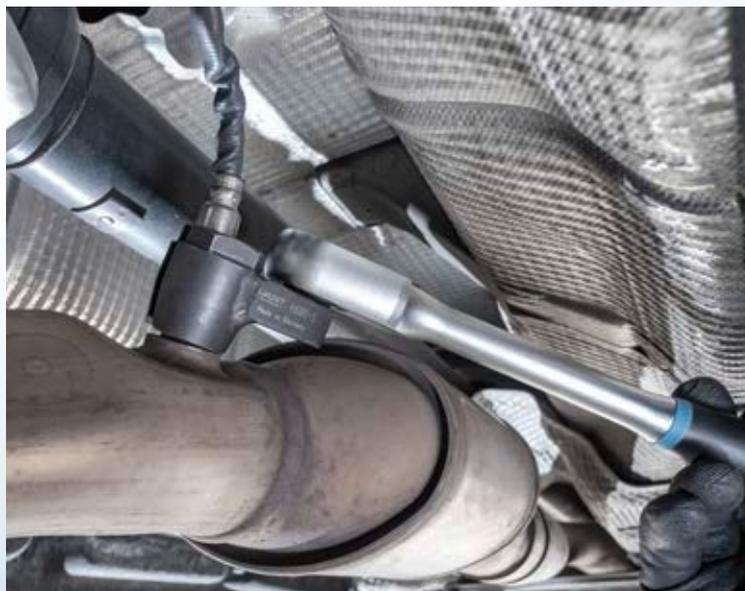
Versione robusta per sonde dei gas di scarico bloccate!
